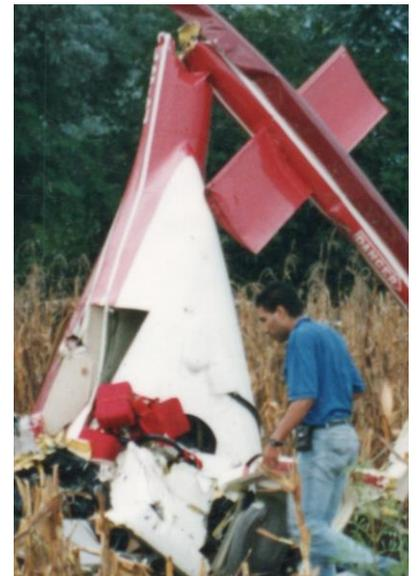
Se analizan las fotografías que muestran la zona inferior del fuselaje del helicóptero para determinar si en la zona de alojamiento del evaporador del aire acondicionado se encuentra evidencia de un orificio. De la inspección de las fotografías ampliadas y del análisis de las marcas se determina que las fotografías no muestran orificios en la superficie de parte inferior del fuselaje.
