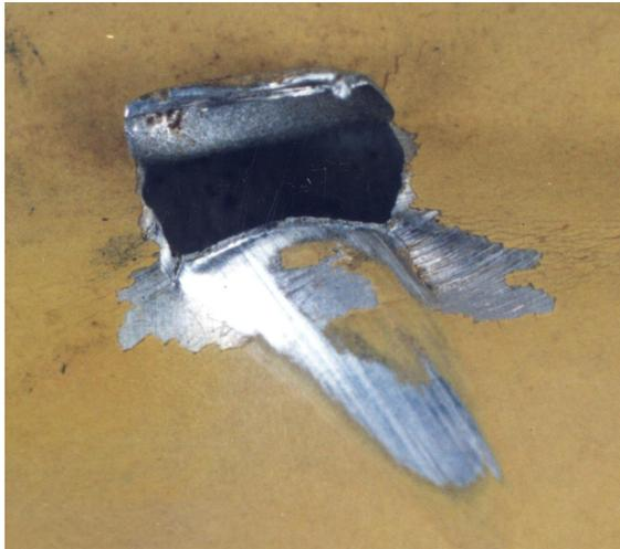
Existe continuidad entre la marca y el orificio. El conjunto marca-orificio puede modelarse con una elipse.
